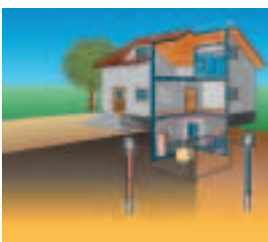
Grundwasser: Entnahme- und Schluckbrunnen
