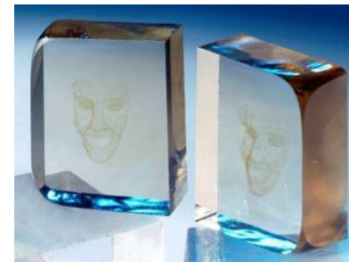
Farbliche Lasermarkie- rung (Ionisierung)
